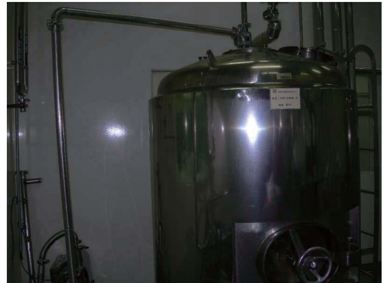
4.此為1,500L儲存桶經過層板在把藥水打入1,500L儲存桶當作儲存。
