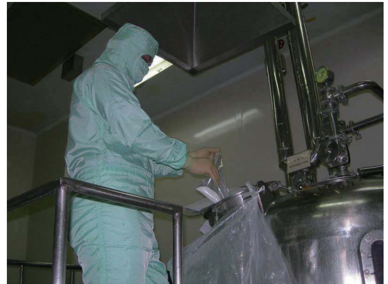
2.打開塑膠袋把藥準備投入1,500L攪拌桶後繼續攪拌至藥劑至溶解完畢。
