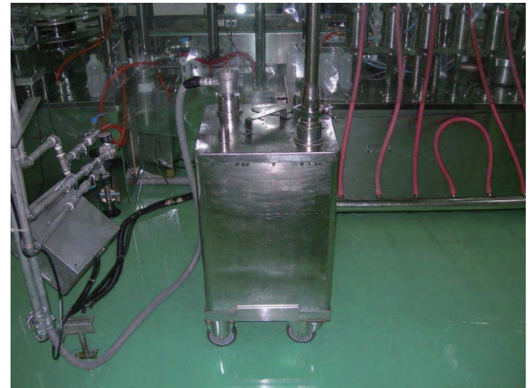
6.此為充填機的儲存筒經過溶解室的儲存桶經過馬達送到此筒此筒子可容納80L的藥液。
