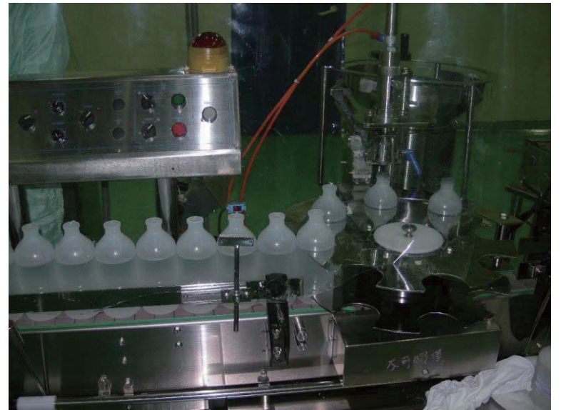
10.充填室的充填機在充填後經過軌道至下一站橡皮塞。
