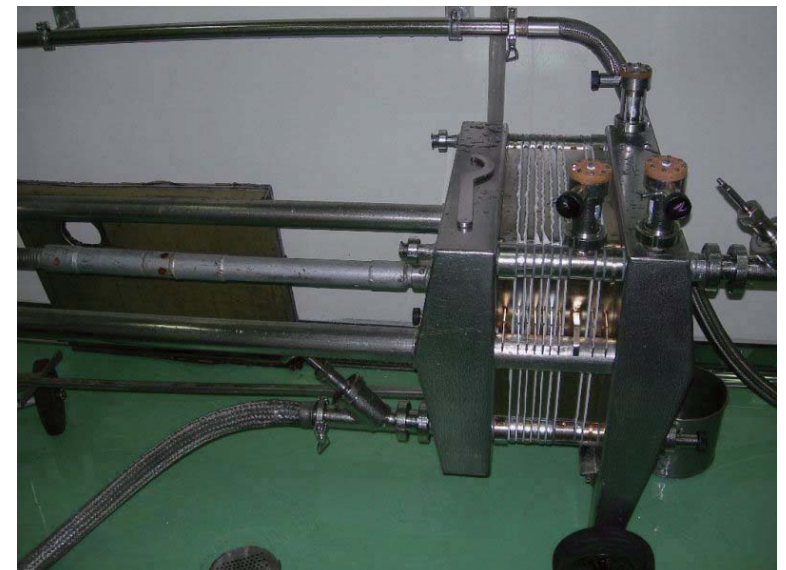
3.此為層板過濾器從溶解桶把藥水經過TOYO filter paper no131的40乘40的濾紙正常SOP的濾紙一層為6張此製品濾紙為54張為9格。
