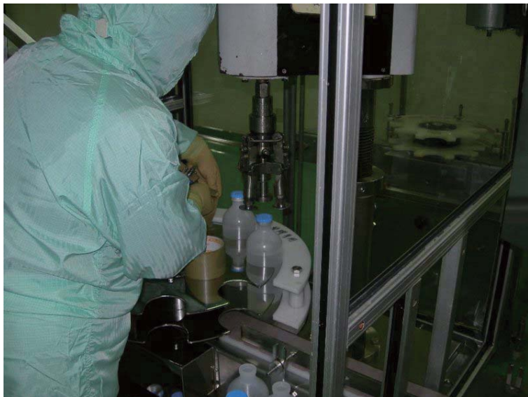
10. 充填室的諦結機締結頭及軌道調整。
