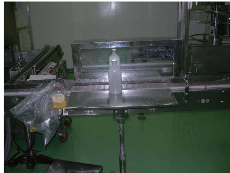
11. 此動作為藥液選別鏡面經過時可以選出液量不足及外觀不良。
