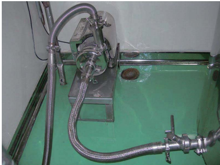
5.此為打藥馬達經過1,500L儲存桶後打藥至充填機的儲存筒。
