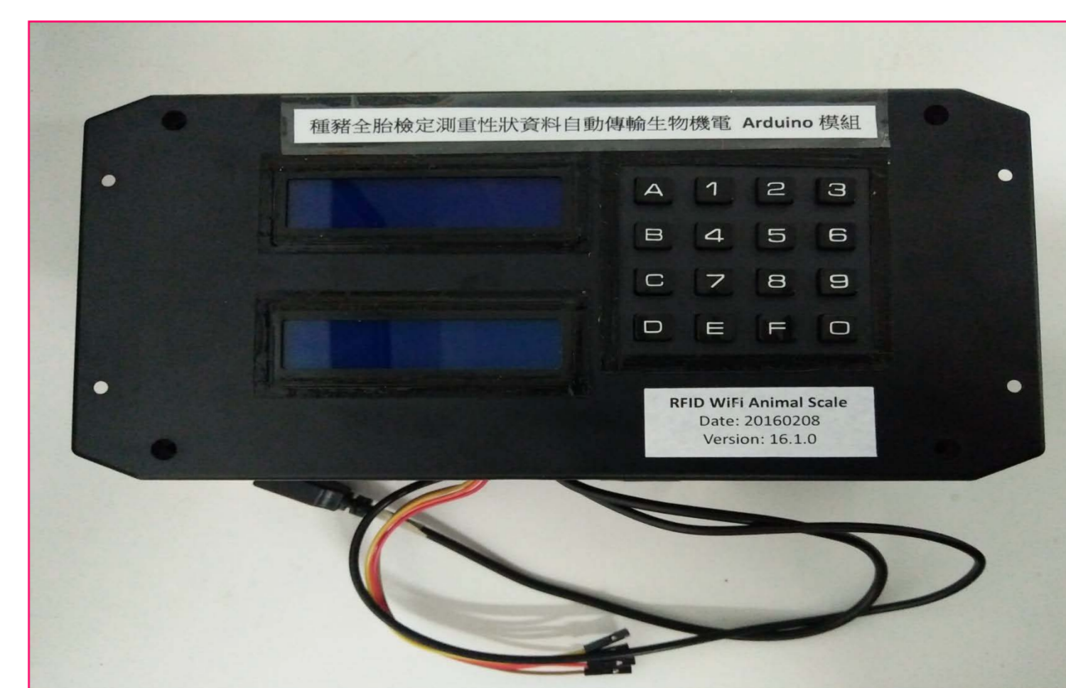
圖2. 種豬全胎檢定測重性狀生物機電 Arduino 模組之成品外觀
