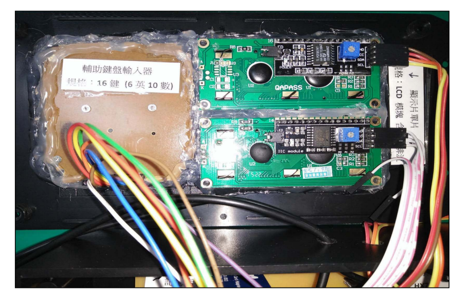
圖3. 模組內有輸入器、顯示晶片、WiFi、無線、記憶卡等組件
