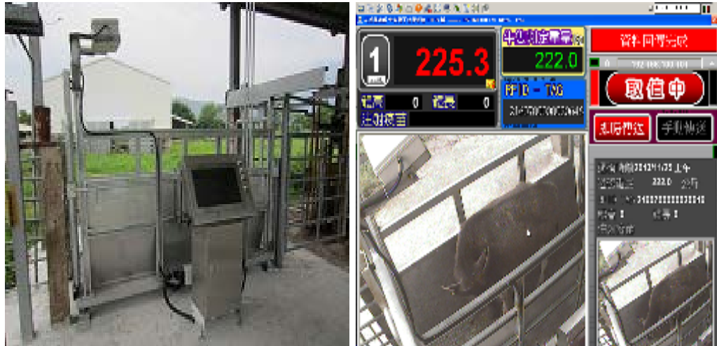
圖4. 自動電子地磅系統。
