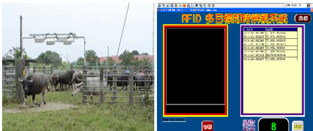
圖5. RFID 多目標搜尋感測系統。
