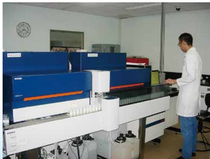
▲乳業協會 DHI 乳質檢驗儀器，可檢驗生乳體細胞數、各項乳成分及酮症等，可協助酪農研判乳牛生理健康及營養狀態，提升乳牛飼養管理。
